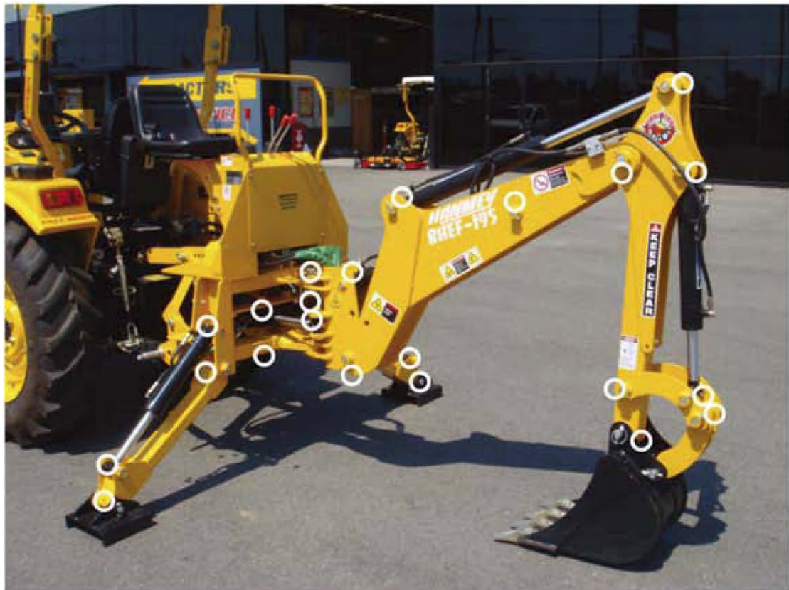
BHEF ja BHUF seeria kaevekoppadel on kokku 27 määrdeniplit, mis asuvad kaevekopa liikuvatel osadel
