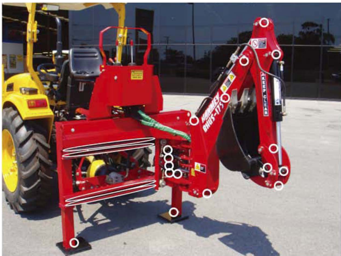
Raami kandetugede liugvardaid tuleb määrada Kokku 19 määrdeniplit BHUF ja BHUS seeria mudelitel Määrdeniplid asuvad igal liikuval osal
